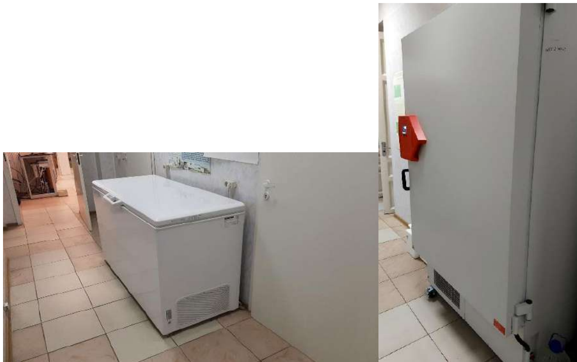
Рисунок 9 – Низкотемпературные холодильники для хранения коллекции тканей и выделенной ДНК. Слева – хранение тканей на -34^{\circ}\text{C} ; справа – ткани и ДНК на долговременном хранении при -84^{\circ}\text{C}
