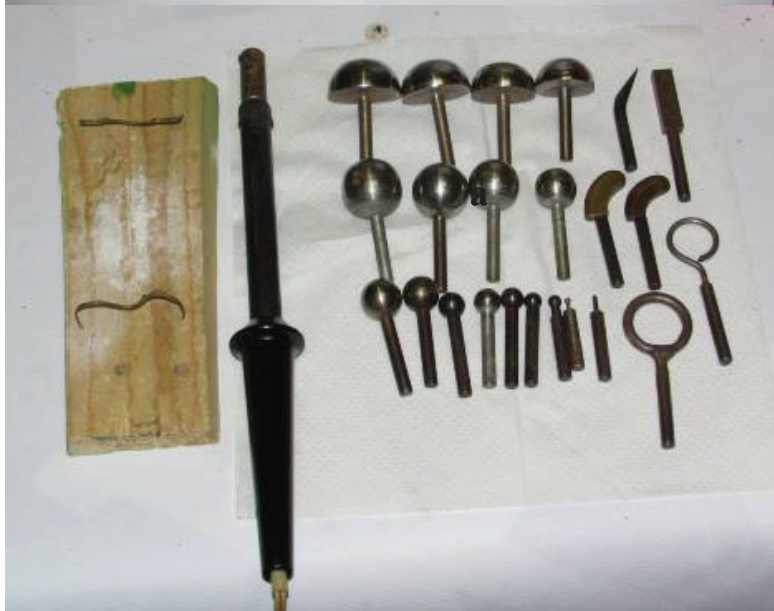
Рис. 1. а) фабричный инструмент для изготовления искусственных растений, б) сменные насадки к паяльнику, изготовленные на заказ
