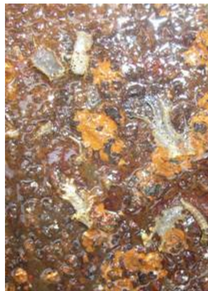
Стальные образцы с лакокрасочным покрытием, подвергавшиеся обрастанию
