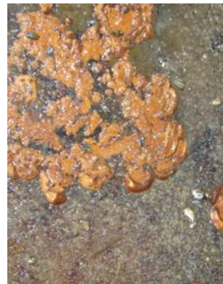
Стальные образцы с лакокрасочным покрытием, подвергавшиеся обрастанию
