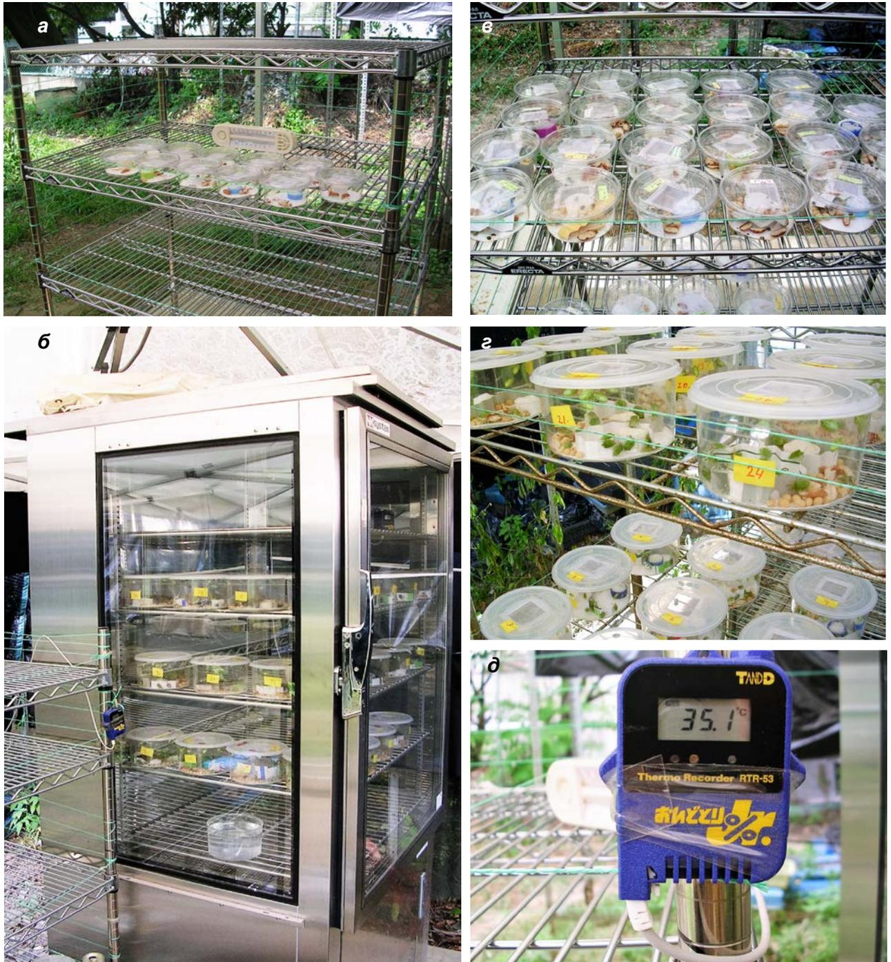
**Рисунок 2.5.** Экспериментальная установка для исследования сезонного развития насекомых в квазиприродных условиях.
