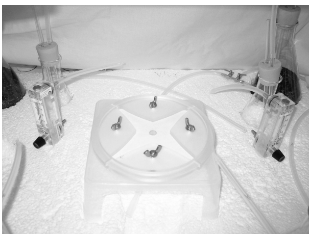
Figur 1. På fotografiet ses et udsnit af olfaktometeropstillingen.
