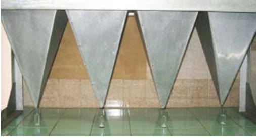
Figura 14.5. Método de extracción de la mesofauna del suelo mediante los embudos Berlese-Tullgren.
