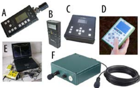
Figura 21.12. Algunos tipos de detectores de murciélagos: Pettersson D 1000 × (A), Pettersson D 240 × (B), Pettersson D500x (C), EM3 Active Ultrasonic (D), Anabat (E) y SM2Bat (F). Los detectores C, E y F pueden emplearse en inventarios y monitoreos pasivos.
