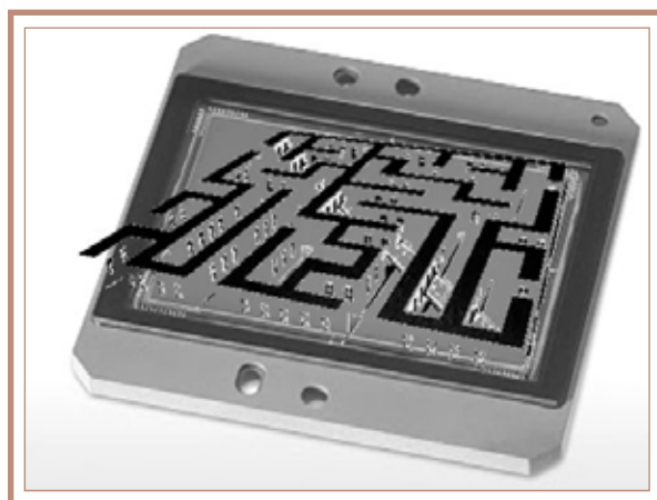
Рис. 4. Накладка лабиринта или трассирующего канала на матрицу должна производиться плавно под углом, чтобы не нарушить поверхность чипа
