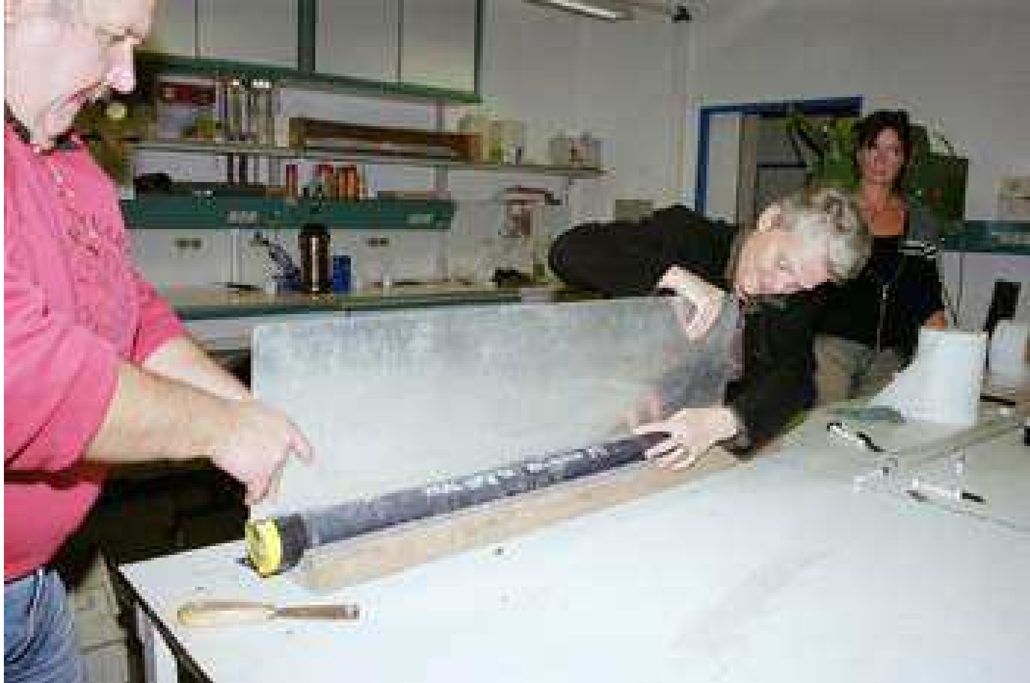
Разрезание керна металлической пластиной и деление его на две половины
