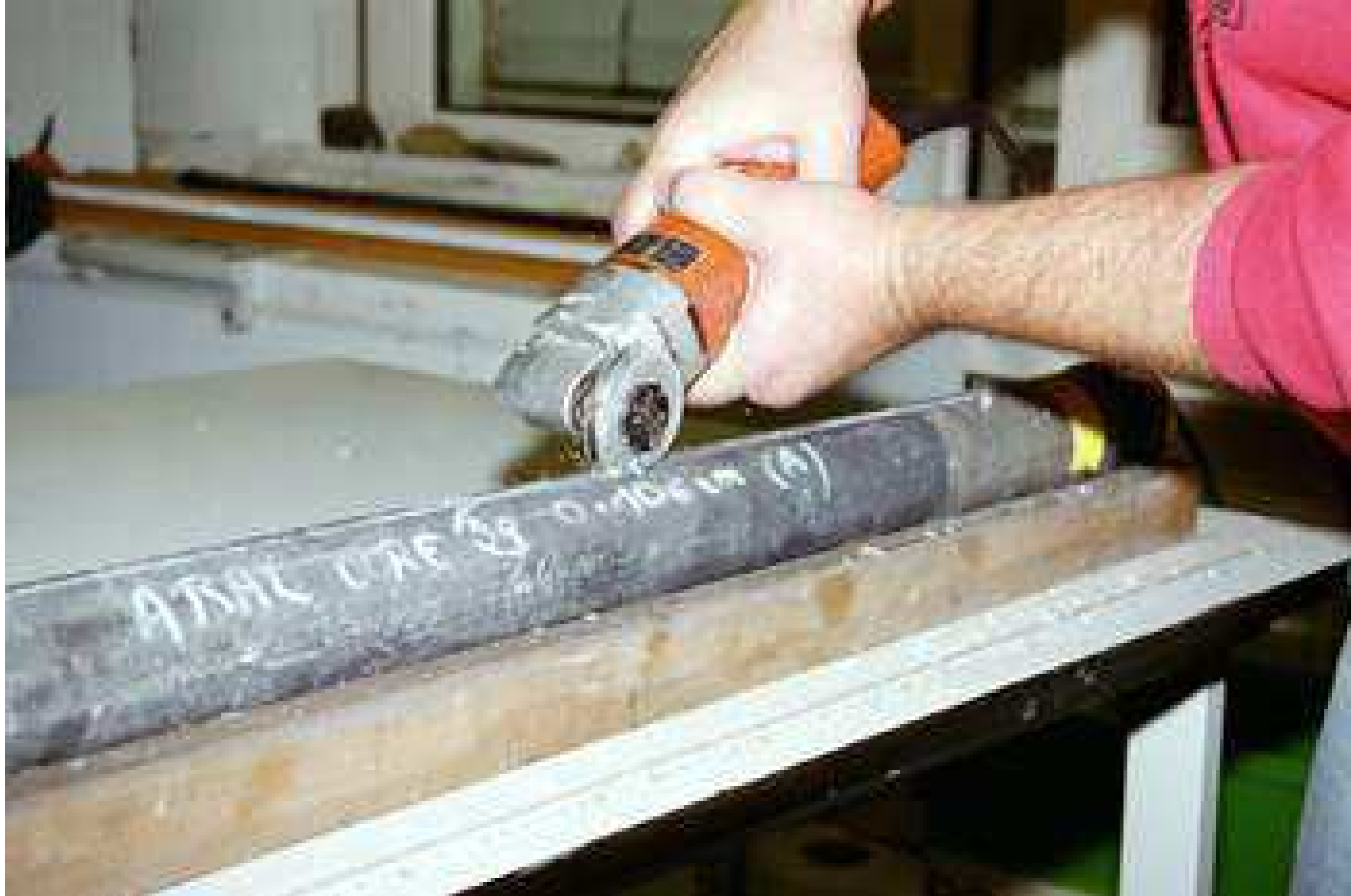
Разрезание пластмассовой трубы с колонкой донных осадков
