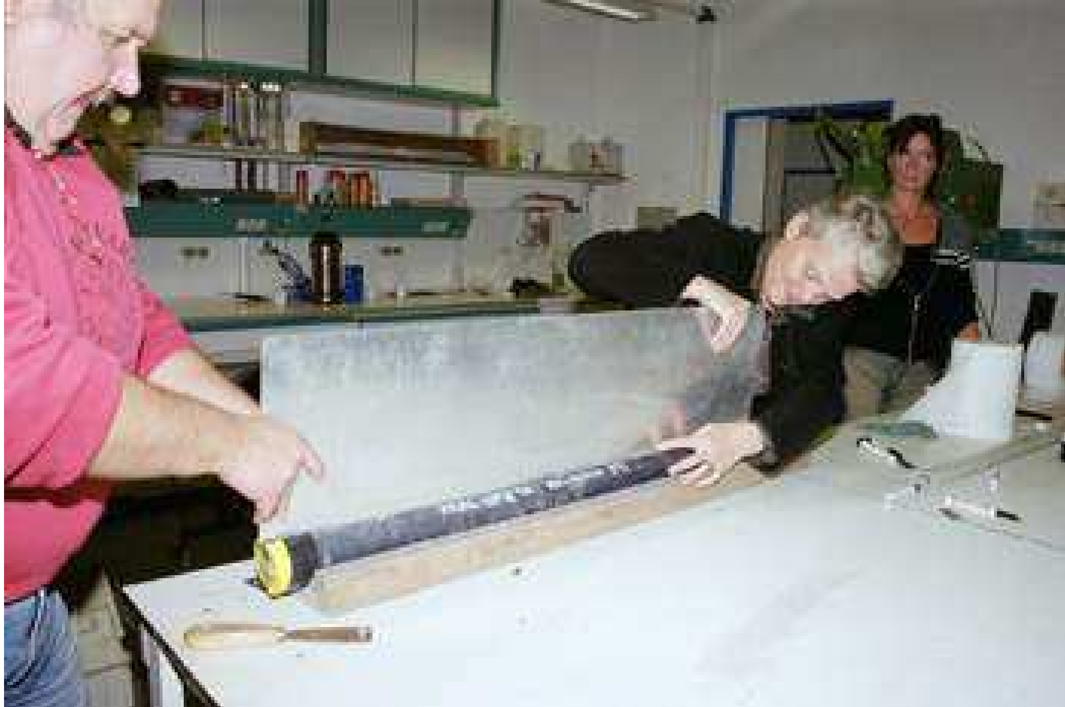
Разрезание керна металлической пластиной и разделение его на две половины
