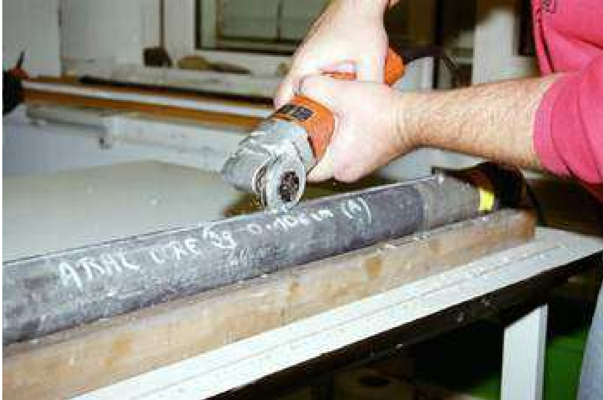
Разрезание пластмассовой трубы с колонкой донных осадков
