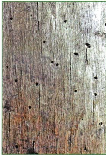
Рис. 5. Точильщик мебельный — Anobium punctatum — выходные отверстия из древесины (ориг.).
