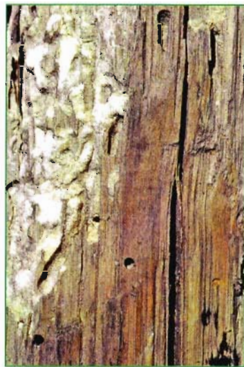
Рис. 3. Древогрыз бороздчатый — Lyctus linearis , поврежденная древесина, вид вдоль древесных волокон (ориг.).
