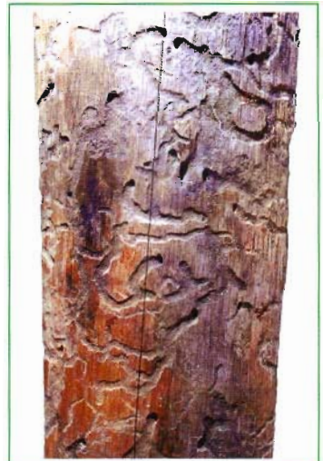
Рис. 4. Повреждение древесины личинкой дровосека хвойного блестящегрудого — Tetropium castaneum (ориг.).
